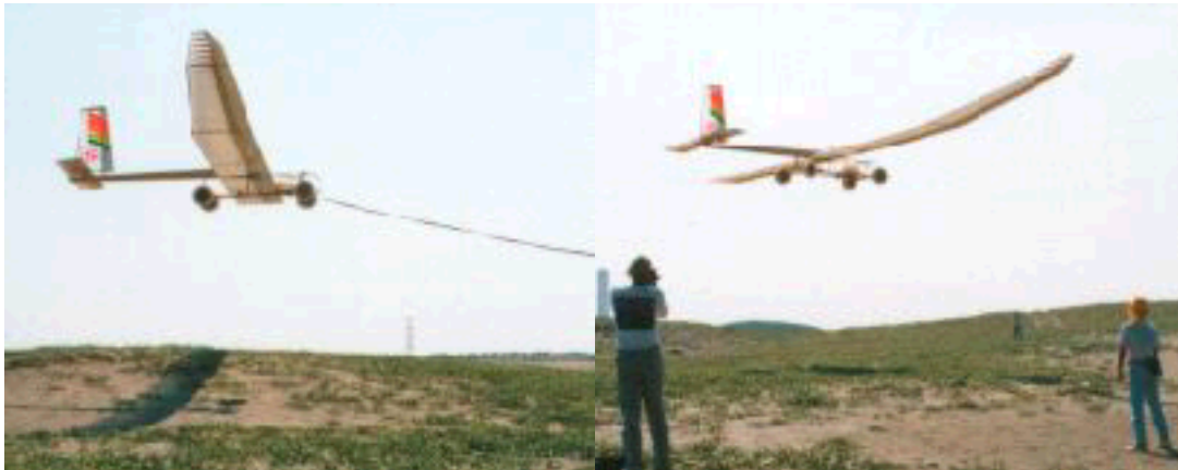
図3 実際のショックコード飛行試験の様子
